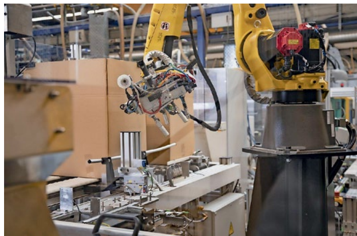
Ein M20i von Fanuc übernimmt das Handling der Bauteile aus einer Roboshot-Spritzgießmaschine von Fanuc, auf der zwei Teile zur Not-entriegelung eines Automatikgetriebes gefertigt werden: ein Steckschlüssel und ein Gehäuseeteil. Foto: Fanuc
